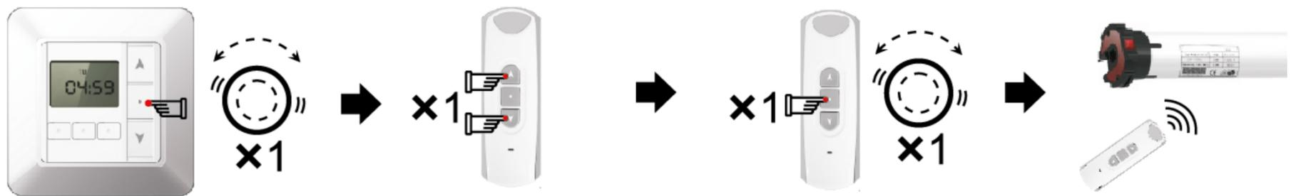
Mettre en marche la tension de service, maintenir le bouton d'arrêt enfoncé pendant 3 secondes, le moteur va vibrer
