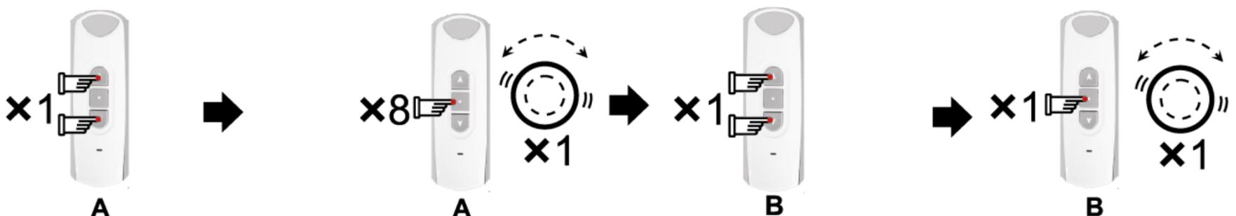
Sur l'émetteur (A), qui est déjà relié au moteur, appuyer simultanément sur les touches de montée et de descente.
